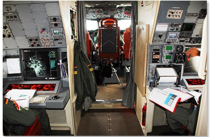
TACCO (links) und NAV-COM-Arbeitsplätze hinter dem Cockpit.
